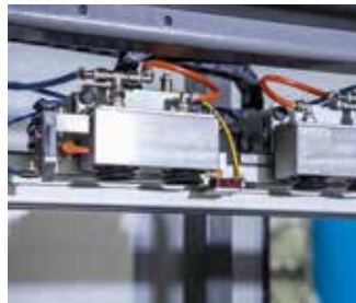
Automatic sheet centering system with double sheet recognition (*patented) Sistema centratura lastra automatico con rilevamento doppia lastra (*brevettato)
