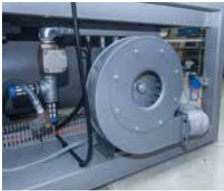
Electric fan for bubbling, vacuum and extraction Elettroventilatore per imbutitura, vuoto ed estrazione proporzionali
